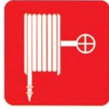
Manguera para incendios
