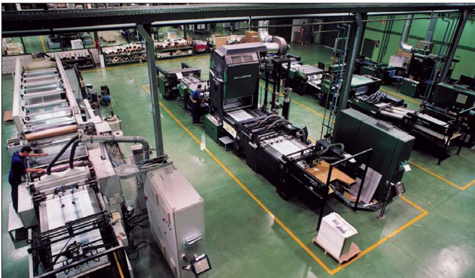
Las señalizaciones en el suelo son una importante medida de seguridad.
